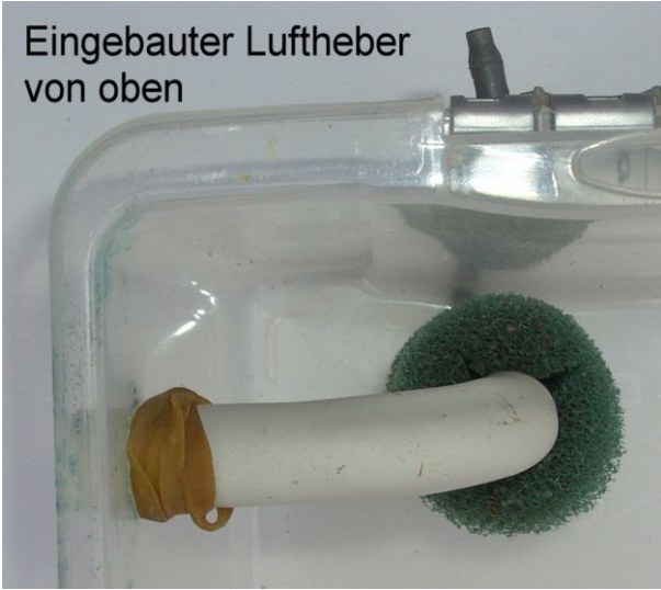
Eingebauter Luftheber von oben
