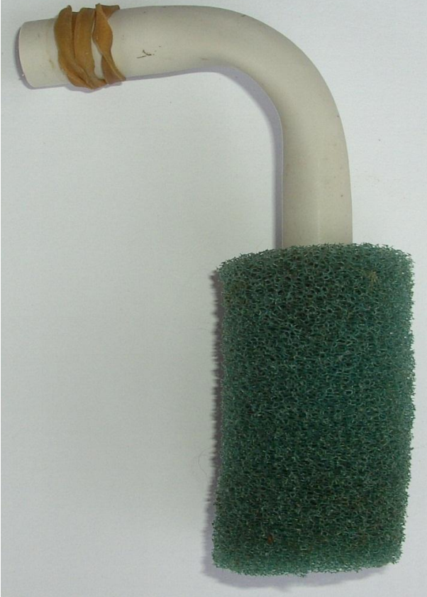
Luftheber mit angesteckten Filterschwamm
